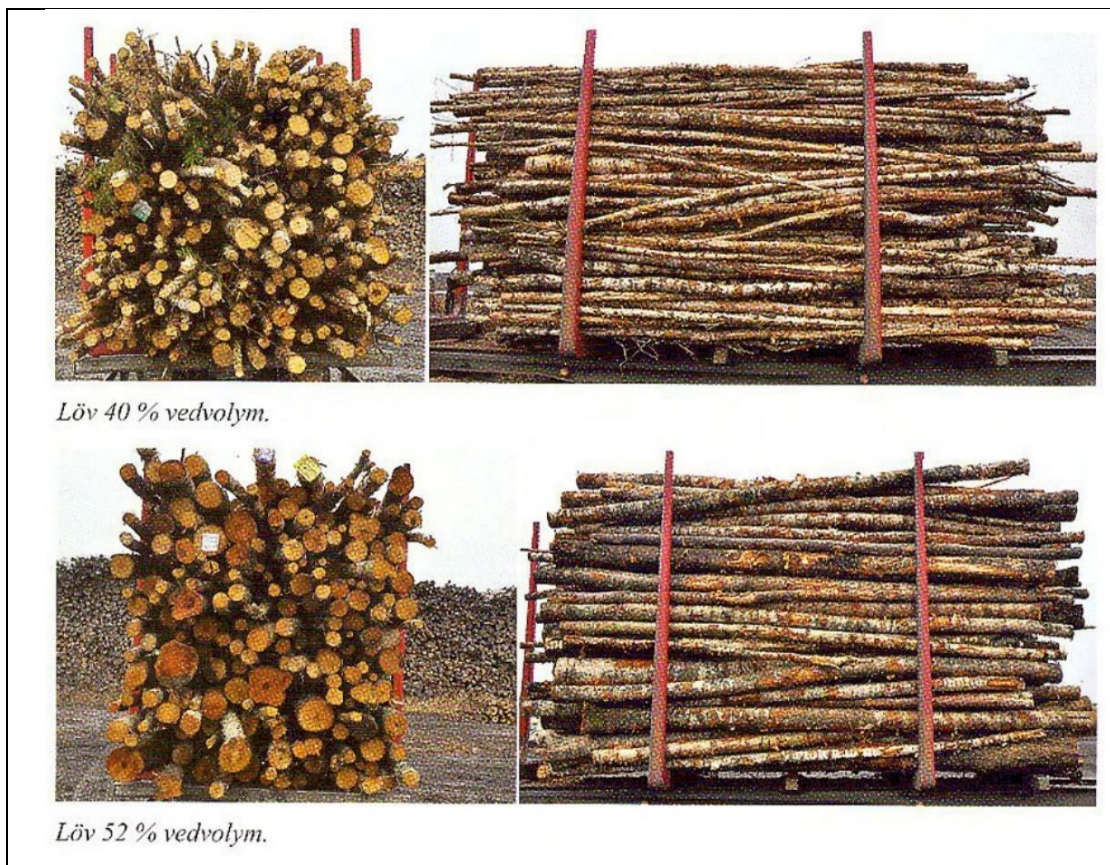
Рис. 2: Внешний вид штабелей березовых балансов, у которых контрольным учётом методом концевых сечений определены коэффициенты полндревесности: 0,40 и (вверху) и 0,52 (внизу). Швеция, 2015 год. Матс Нулиндер, Ханс Фрук, учебник "Балансы" (Massaved), стр. 70
