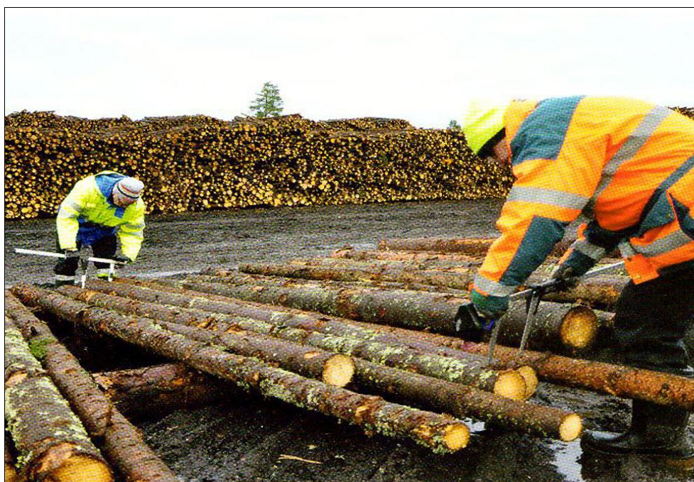
Рис. 3: Контрольный выборочный учёт балансов в Швеции методом концевых сечений с измерением верхнего и нижнего диаметров на расстоянии 10 см от торца и длины лесными вилками с автоматической регистрацией результатов. Как следует из рисунка отклонения длины балансов в штабеле могут достигать 2 м. Швеция, 2015 год. Матс Нулиндер, Ханс Фрук, учебник "Балансы" (Massaved), стр. 87
