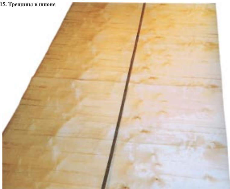
Фото 15. Трещины в шпоне
